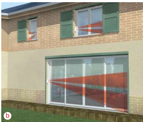
➔ Na obwodzie budynku (a), przy oknach i drzwiach (b) montuje się bariery mikrofalowe i podczerwieni. OPTEX SECURITY
