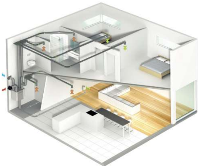
📍 Schemat instalacji wentylacyjnej z odzyskiem ciepła. VASCO
