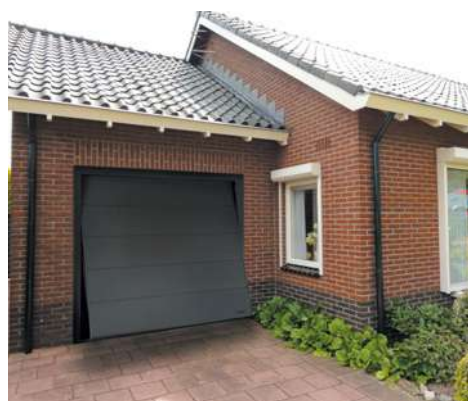
📌 Brama uchylna potrzebuje wolnego miejsca przed garażem, bo podczas otwierania zachodzi na podjazd. WIŚNIEWSKI
